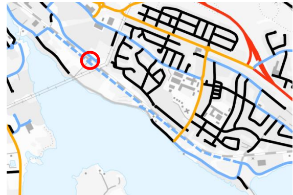
Strandvägens nya dragning (blå sträckad linje) och ny planskild korsning med järnvägen (röd ring)
