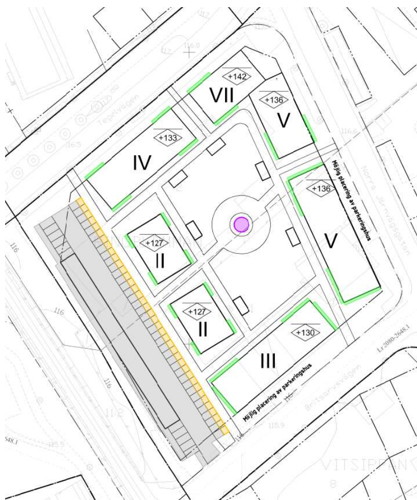
Figur 14. Alternativ placering av infiltrationsstråk (gult) och parkering (grått).
