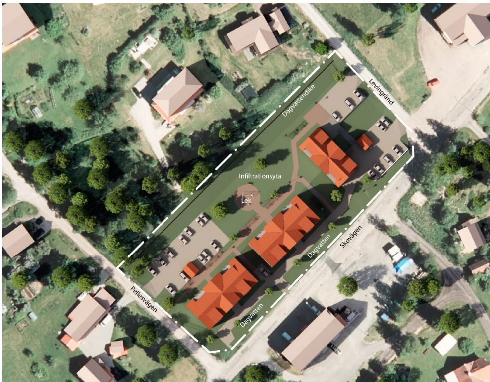
Figur 9. Illustrationsplan med föreslagna lägen med ytor för fördröjning av dagvatten. Se även större format i Bilaga, illustrationer. Illustration: Mondo arkitekter.
