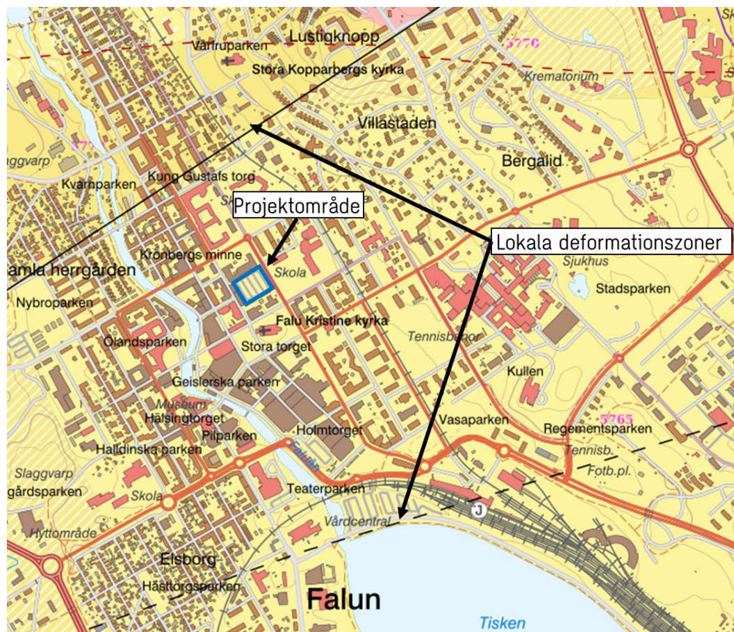
Figur 2. Berggrundskarta hämtad från SGU, 2023 (Skala 1:10000). I området dominerar bergarten Ryölit (det gula området). Deformationszonernas lägen är inte exakta utan anvisar bara ungefärligt läge.
